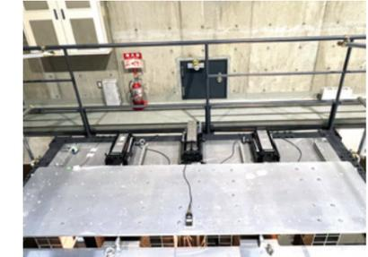
設備耐震実験用振動台
