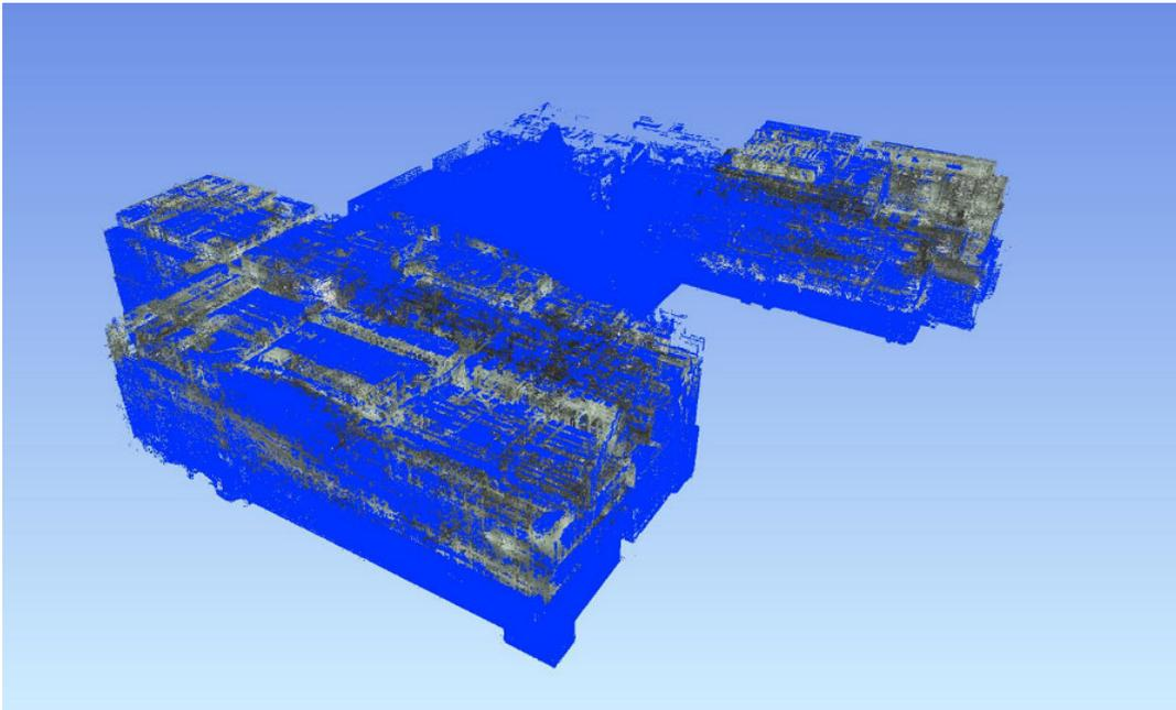
資料3 青：ライダーによるスキャン箇所 実画像：ドローンによるスキャン箇所
