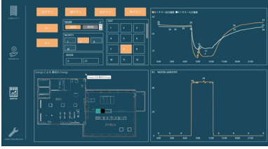
BEMS(エネルギー管理): 各所の計測データを収集・解析し、エネルギー消費を最適化します。
